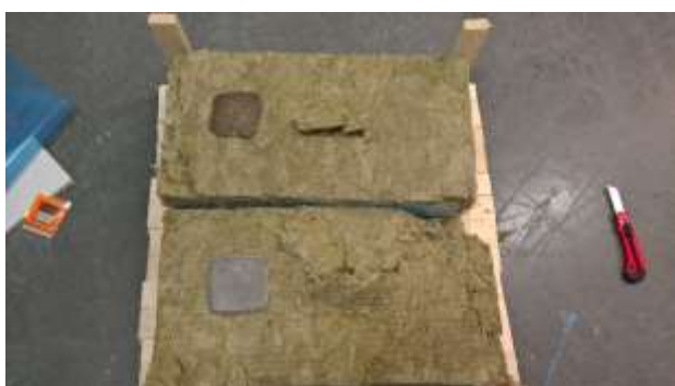
Ulkoseinärakenne. Villat jaettu kahtia demojärjestelyä varten. Vigilanin esivaletut anturit vasemmalla.
