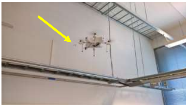
Drone lukee Smartrac anturia. Anturi merkitty nuolella.
