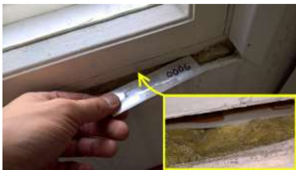
Anturi ikkunan alapokan alle
