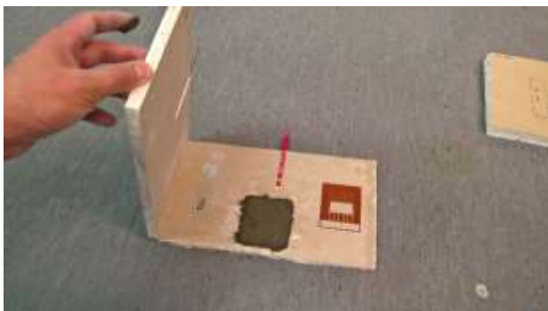
Anturien toiminnan kokeilua kipsilevyrakenteessa. Vasemmata Smartrac, Vigilan ja InviSense
