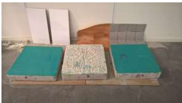
Testilaatat odottamassa pinnoitusta. Kesimmäiseen on jo levitetty liima muovimattoa varten.
