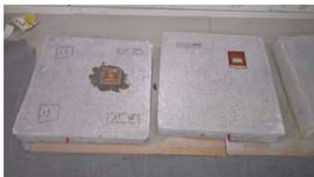
Antureita kuivuneiden valujen sisällä ja pinnalla
