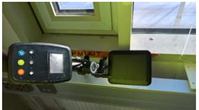
Alumiininen johtokotelo estää anturin lukemisen
