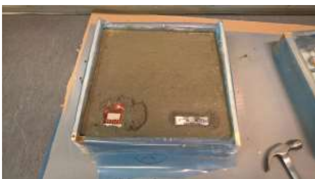
Antureita sijoitettiin eri syvyyksille betonivaluun
